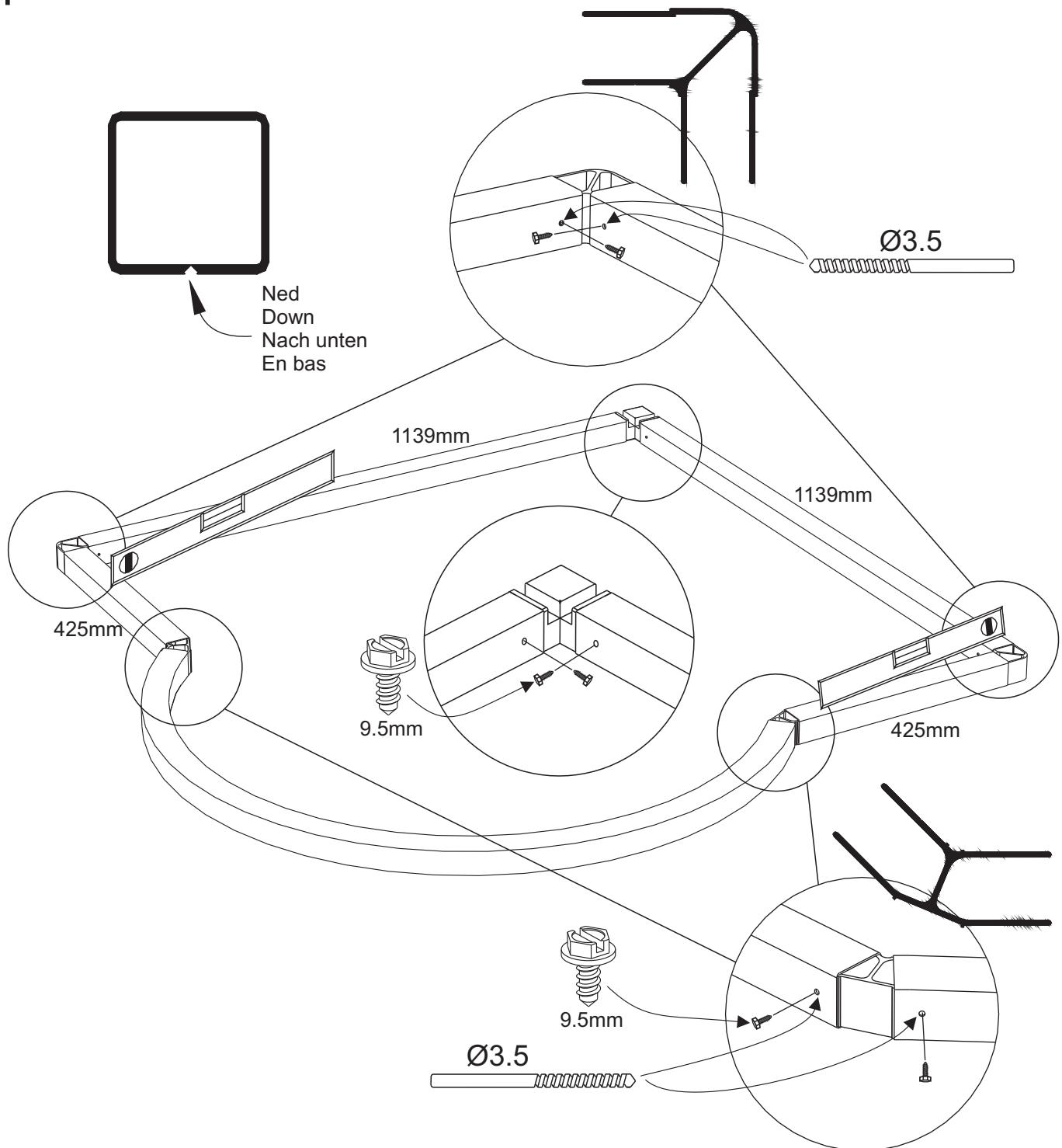
Lägg ut golvramarna. Kontrollera att ramen ligger plant, använd vattenpass. Är ramen inte plan, justera genom att palla upp på nödvändiga ställen under golvramen. OBS! Det är ett absolut krav att golvramen ligger plant "i väg" för att slutresultatet skall bli perfekt.
