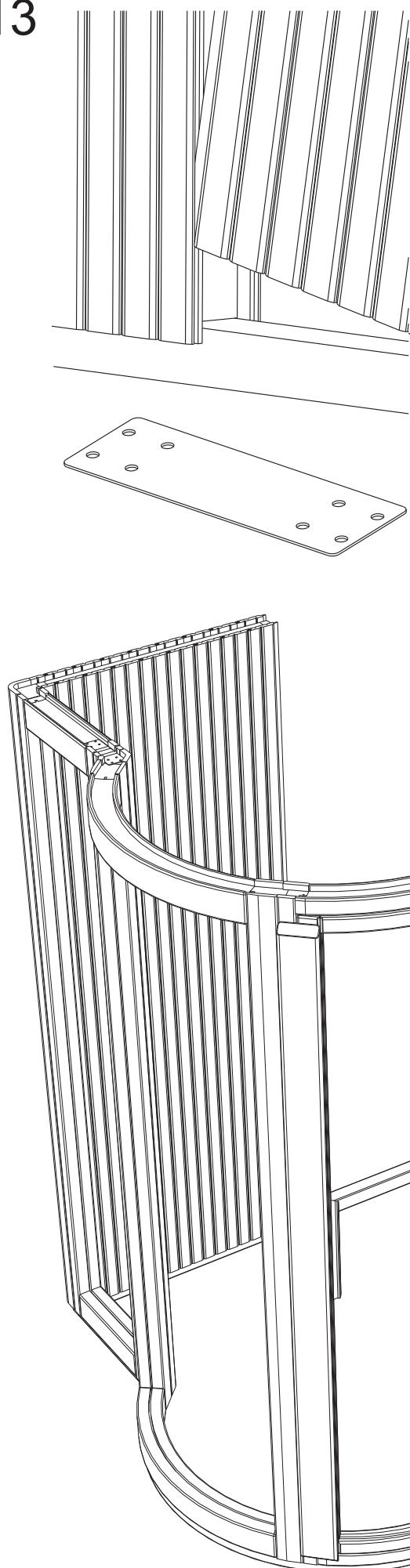
Slå försiktigt in sektionen ordentligt på plats, använd en träklots under hammaren så undviker du skador på sponten.
